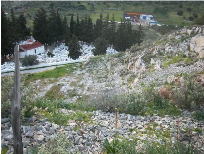
Εικόνα 97: Η «καρδιά» του λατομείου απέναντι από το νέο νεκροταφείο. Εδώ ο πλακοειδής ασβεστόλιθος είναι σχεδόν κάθετος και διευκολύνεται η απόσπαση με σιδερένιες σφήνες.
