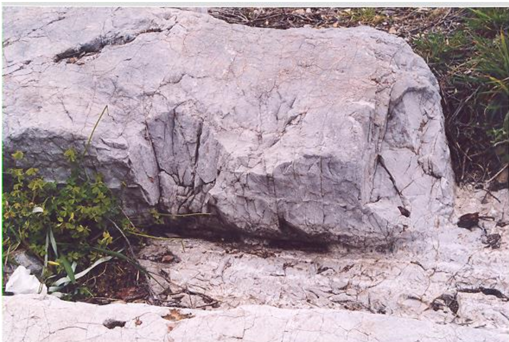
Εικόνα 10: Στα λατομεία στον λόφο του Φιλοπάππου ο κοκκινωπός ασβεστόλιθος είναι πολύ συνεκτικός και σε μεγάλους όγκους. Στην εικόνα βλέπουμε ένα μεγάλο μπλόκι που έχει με αυλάκια ξεχωριστεί από την κύρια μάζα του πετρώματος και στη βάση του έχει ανοιχθεί αυλάκι όπου έχουν φτιαχτεί φωλιές, ώστε να αποκολληθεί το μπλόκι από τη βάση του.
