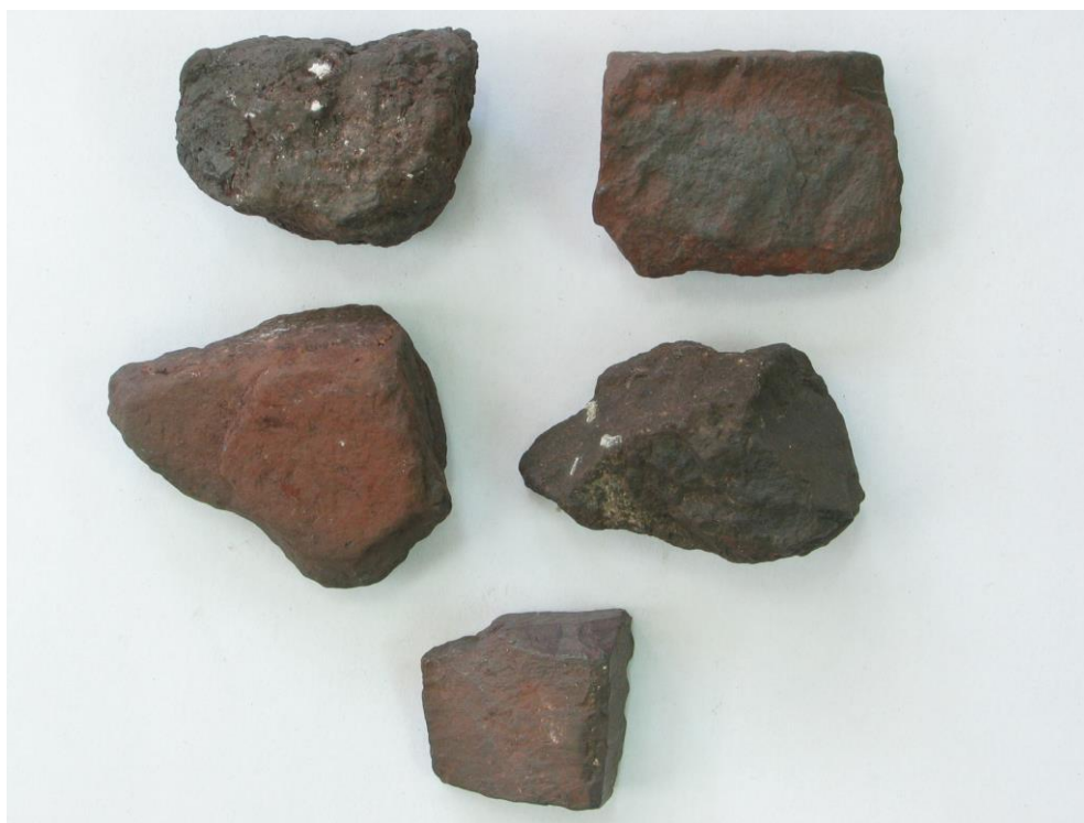
Εικόνα 11. Κομμάτια μεταλλεύματος σιδήρου (Αιματίτης) που τροφοδοτούσαν τις υψικαμίνους της ΧΑΛΥΒΟΥΡΓΙΚΗΣ στην Ελευσίνα. Μήκος περίπου 2-3 εκατοστά. Λίγο μικρότερα ήταν των αρχαίων καμινιών.
