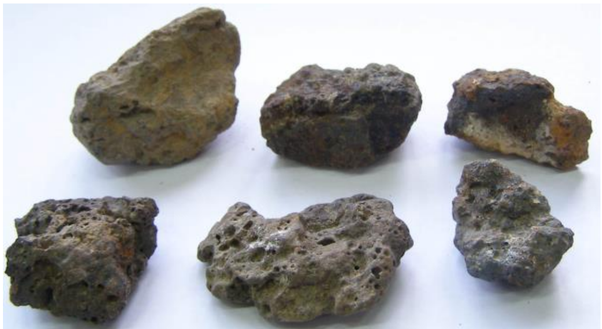
Εικόνα 18. Μεγάλα κομμάτια σκωριών. Το ειδικό τους βάρος εξαρτάται από τη σύστασή τους και από τους πόρους τους.
