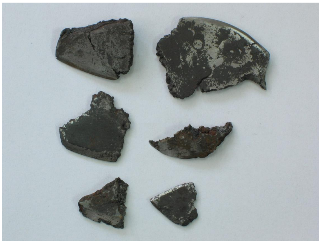
Εικόνα 14. Κτυπημένα με σφυρί τα ελάσματα και τροχισμένα. Θα τα χαρακτηρίζαμε πρωτόλεια εργαλεία κοπής και διάτρησης γιατί είναι γεμάτα με ρωγμές και εγκλείσματα σκουριάς. Αυτό οφείλεται στο ότι δεν ολοκληρώθηκε το καμίνι, είναι δηλαδή ενδιάμεσα προϊόντα.
