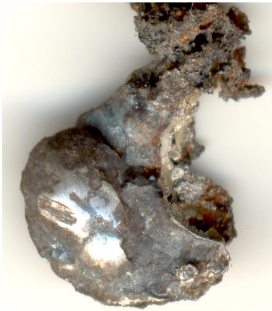
Εικόνα 16. «Δάκρυ» σιδήρου πολύ υψηλής θερμοκρασίας, κατερχόμενο προς τον πυθμένα του καμινιού, Αφήνει πίσω του σκωρίες και ρωγμές και ταξιδεύει συμπαγές προς τον πυθμένα να ενωθεί με τα όμοιά του.
