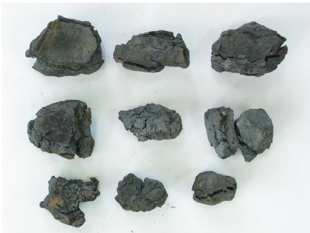
Εικόνα 12. Είναι τα κομμάτια της Εικόνας 11 που μέσα στο καμίνι ήσαν ερυθροπυρωμένα, το μονοξείδιο του άνθρακα τούς είχε αφαιρέσει το οξυγόνο και έτσι είχαν μετατραπεί σε μεταλλικό σίδηρο με πολλές ρωγμές και εγκλείσματα σκωριών, έτοιμα να κατηφορίσουν προς τον πυθμένα και να ενοποιηθούν σε μια μάζα. Ελήφθησαν από τον γράφοντα με το χάλασμα του καμινιού πριν ολοκληρωθεί ο κύκλος του.
