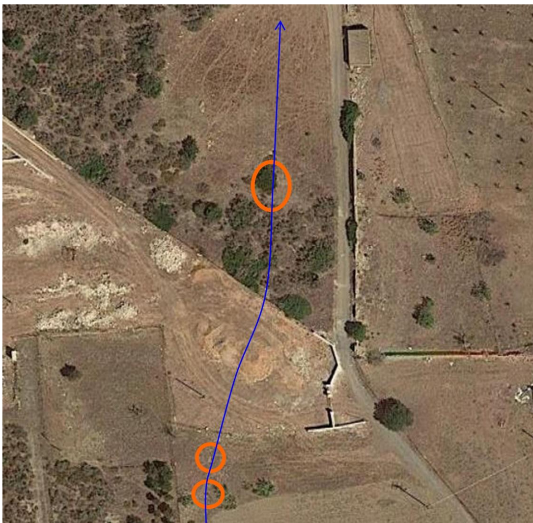
Εικόνα 88. Στους κύκλους τμήματα που έχουν βουλιάξει ή σκαφτεί και έχει αποκαλυφθεί το υδραγωγείο. Το υπόλοιπο είναι αόρατο και κανείς δεν μπορεί να υποψιαστεί την ύπαρξή του.
